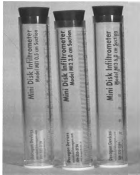
Figure 2.2: Mini disk infiltrometer (Decagon Inc., 1998)
